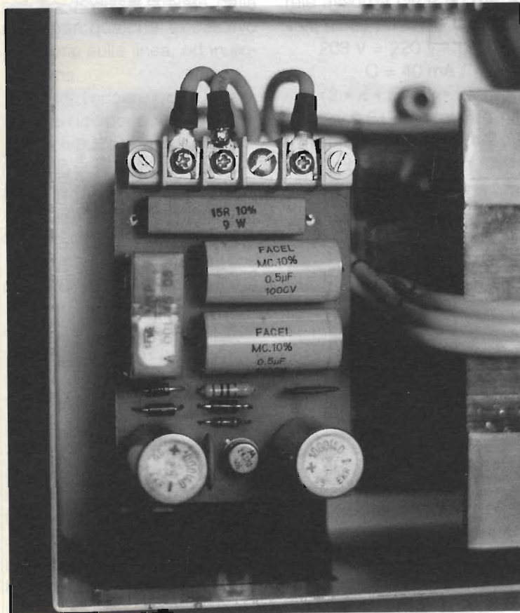
figura 3 - Disposizione componenti piastrina soft-start.
