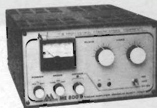
Amplificatore lineare 26-30 MHz; 800 W PeP AM-FM-SSB-CW
